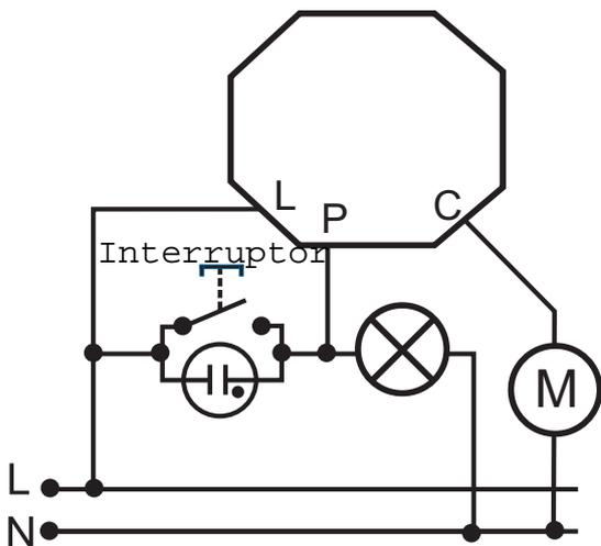
Ejemplo de sustitución de una instalación conmutada por una instalación con **minutero + pulsador**
